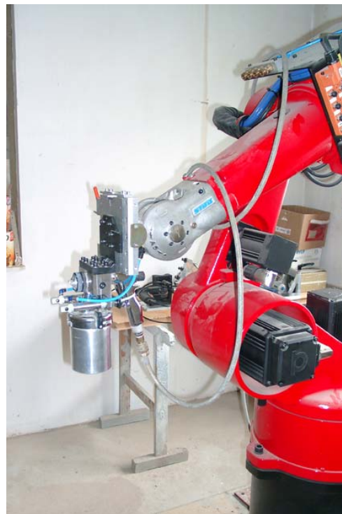
Woodworking Assistant with an adaptor for spraying / Schreinereiassistent mit Sprühvorrichtung zum Lackieren
