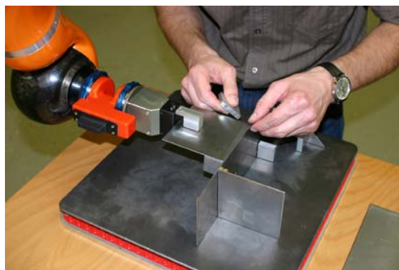
Example for a scenario of human-robot cooperation at the manual workplace / Beispielszenario für die handwerkliche Zusammenarbeit von Mensch und Roboter
