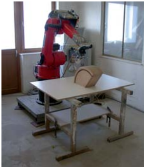
The Woodworking Assistant spraying a wooden workpiece Der Schreinereiassistent beim Lackieren eines Holzteils
