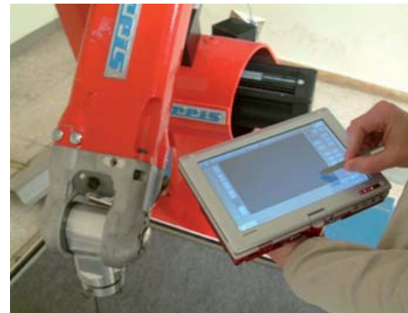
Intuitive man-machine interfaces including graphics-based input options Intuitive Mensch-Roboter-Schnittstelle mit grafikbasierten Eingabemöglichkeiten
