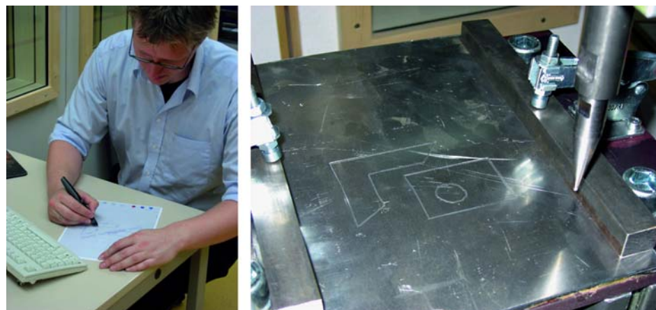
Bild 4 Exakte Bahngenerierung aus Handskizzen mit digitalem Stift.
