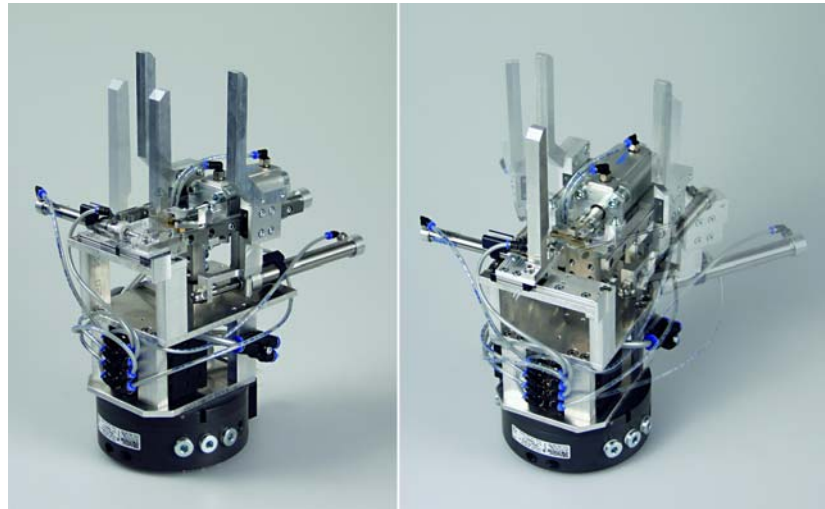
Bild 8 Greiffinger-Konfigurationen zur Aufnahme verschiedener Geometrien.
