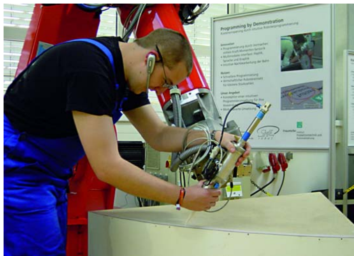
Bild 7 Klebprozesses durch manuelles Führen des Roboters.
