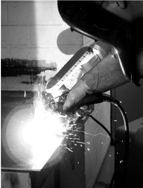
Bild 1 Assistenzroboter rob@work beim assistierten Lichtbogenschweißen.
