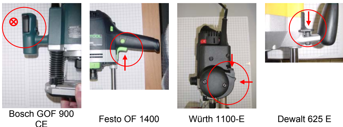
Abbildung 16: Unterschiedliche Anordnungen und Betätigungsarten der Schalter zum Ein- und Ausschalten der Handoberfräsen
