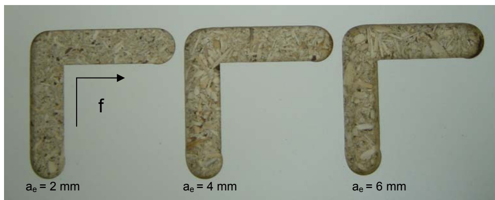
Abbildung 42: Gestaltabweichungen bei unterschiedlichen Zustelltiefen
