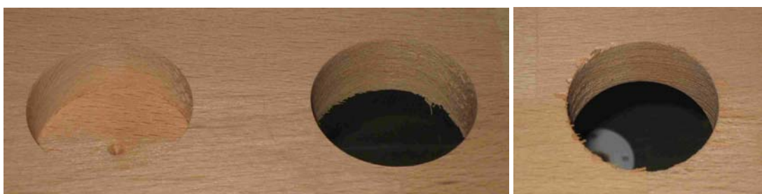
Abbildung 59: mit Scharnierfräse gebohrte Löcher
