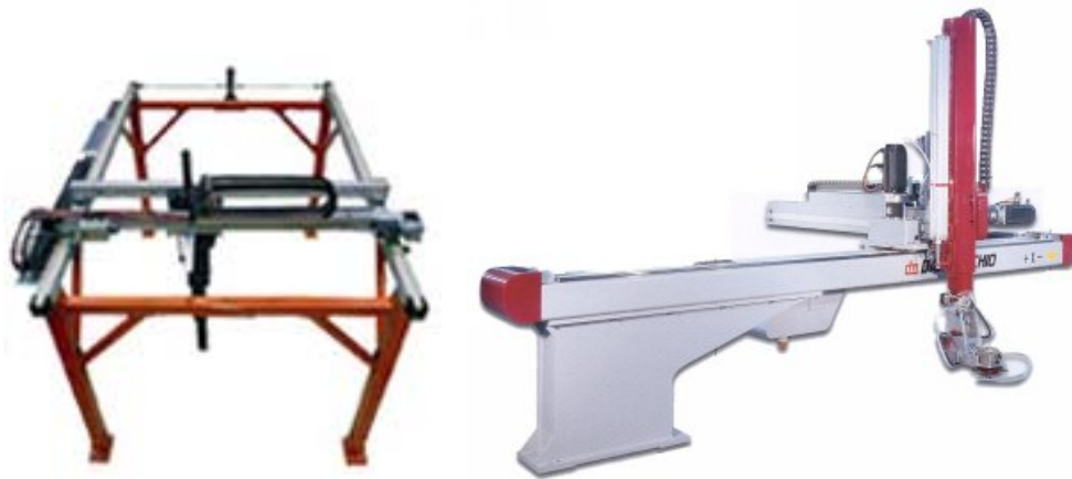
Abbildung 2: Portalroboter (links) [ABB05] und Ausleger (rechts) [INT1]
