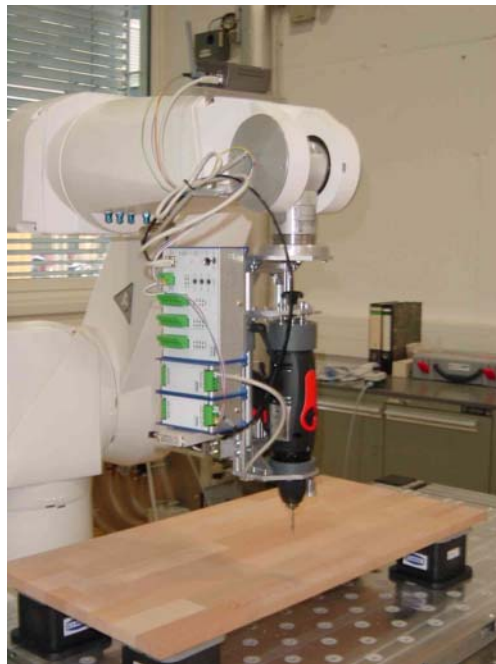
Abbildung 53: Versuchsstand mit Roboter, Bohrwerkzeug und Aufspanntisch
