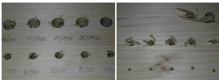
Abbildung 56: ausgerissenes Material bei Fichtenholz, Oberseite links, Unterseite rechts
