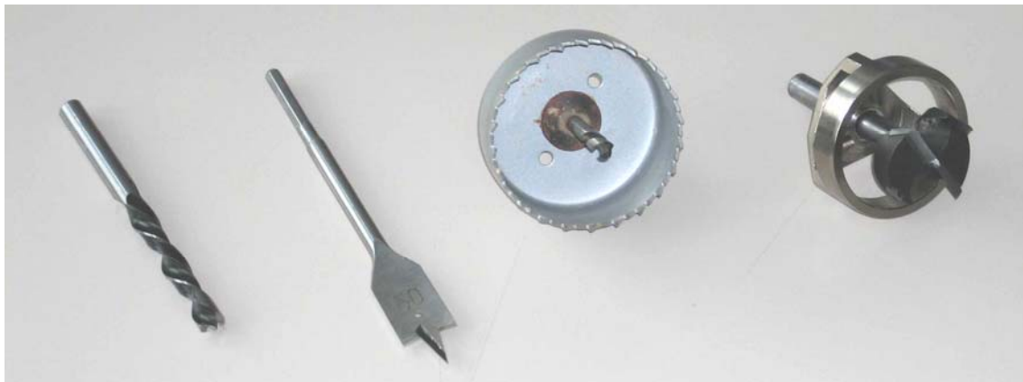
Abbildung 54: Spiralholzbohrer, Astlochbohrer, Lochsäge und Scharnierfräse
