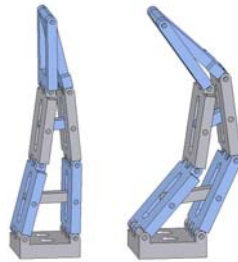
Abbildung 18: CAD-Modelle eines Finray-Fingers
